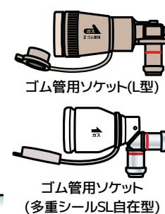
ホースエンドガス栓の口径に合わないソフトコードを使用しないでください
